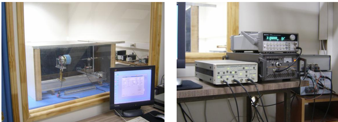
FIG. 3.4 – Description qualitative du montage expérimental utilisé. La photo de gauche montre la partie mécanique (banc expérimental, dispositif de génération des anneaux, anémomètre, moteurs pas à pas, axes horizontal et vertical) protégée des écoulements parasites de la pièce par une cage. La photo de droite montre la partie électronique (générateur de fonctions, amplificateur de puissance, filtre, boîtier de commande des moteurs et carte d'acquisition). L'interface graphique de la figure 3.8 apparaît sur l'écran du PC.
